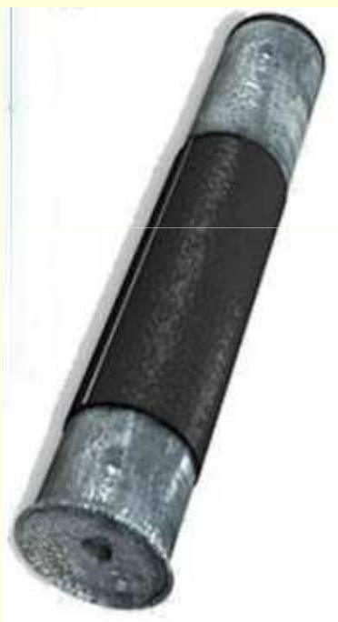
Rekonstrukce mikroskopu Zachariase a Hanse Janssenových z roku 1590 Tento mikroskop zvětšoval 3x až 9x
